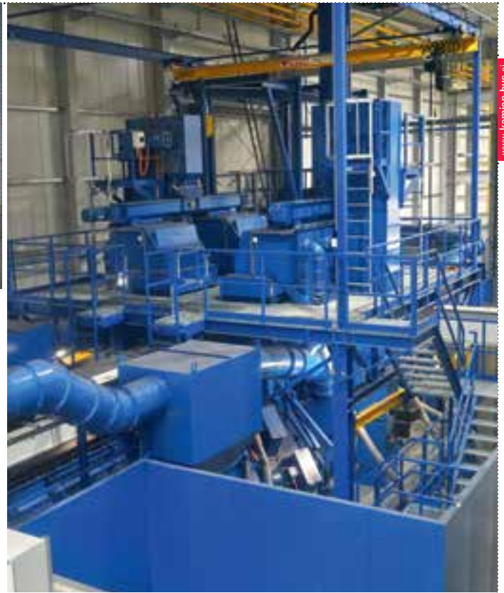
Naprave za peskanje so impresivne velikosti, postopek pa je popolnoma avtomatiziran.
