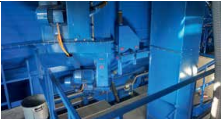
22 strateško razporejenih turbin porabi okoli 25 ton kovinskih kroglic za čiščenje vsake posamezne šasije.
